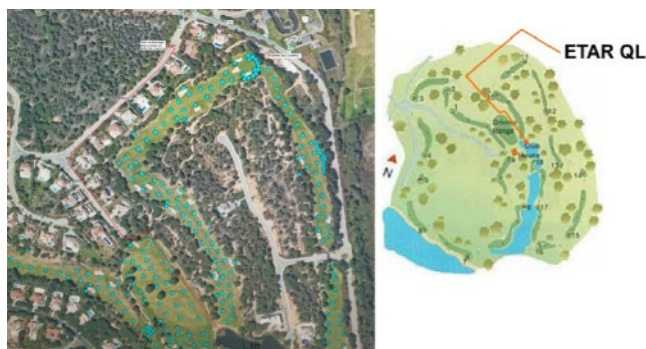
Figura 5. Layout do campo de golfe de San Lorenzo (localização do ponto de entrega da ApR e do lago utilizado para a rega) e adução entre a ETAR e o lago de rega.
